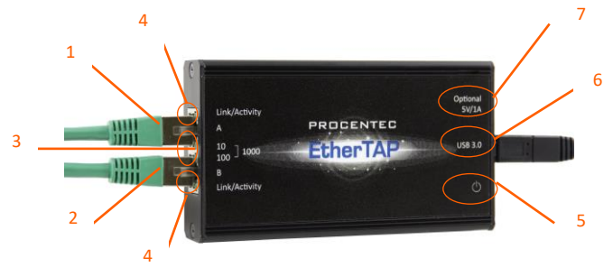
Abbildung 2: Kennzeichnung von Anschlüssen und LED für die 1Gbit Version
